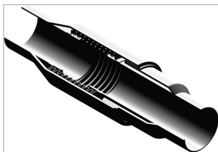
Rysunek 14. Kompensator jednorazowy – przeznaczony do montażu w rurociągach z podgrzewem wstępnym
