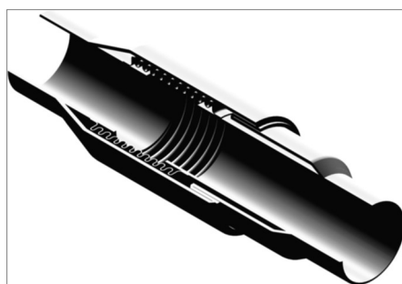
Rysunek 13. Kompensator jednorazowy – przeznaczony do montażu w rurociągach z podgrzewem wstępnym
