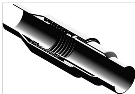
Rysunek 11. Kompensator jednorazowy – przeznaczony do montażu w rurociągach z podgrzewem wstępnym
