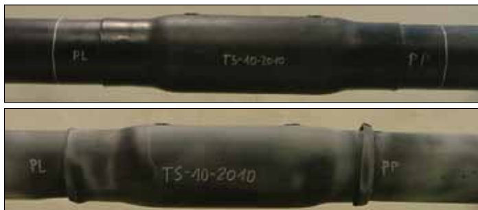
Fot. 6, 7. Złącze z nasuwką zgrzewaną elektrycznie: - na górze - przed badaniem, na dole - po badaniu
