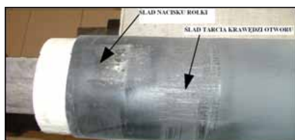
Fot. 14. Odkształcenia płaszczu osłonowego spowodowane naciskiem rolki oraz tarciami o krawędź otworu skrzyni. Stan po 870 cyklach ruchów osiowych
