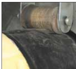
Fot. 13. Położenie rury w otworze skrzyni po około 100 cyklach ruchów. Płaszcz osłonowy opiera się o rolkę oporową
