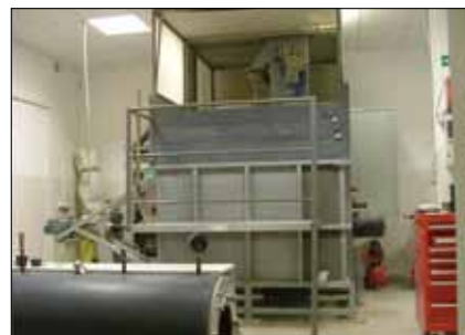
Fot. 1. Widok stanowiska do badania obciążenia od gruntu (tzw. „skrzyni z piaskiem”)
